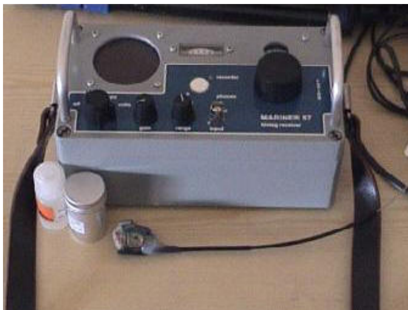
Fig. 4: Apparato ricevitore e trasmittente di lunga vita. I due barattolini contengono la resina bicomponente ed il solvente per rifare l'involucro della trasmittente dopo il cambio della batteria.
