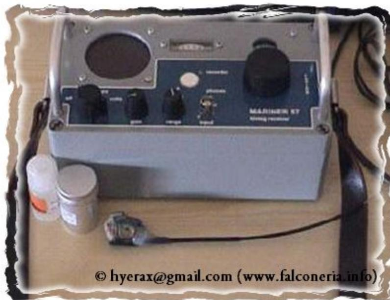
Fig. 4.0.e: Apparato ricevitore e trasmittente di lunga vita. I due barattolini contengono la resina bicomponente ed il solvente per rifare l'involucro della trasmittente dopo il cambio della batteria.
