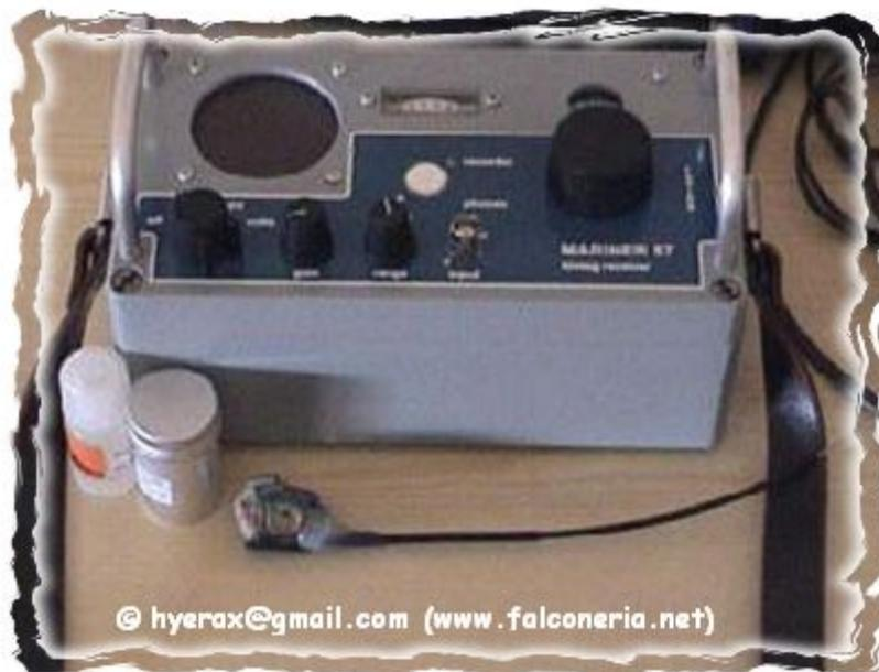
Fig. 7.10.d: Apparato ricevitore e trasmittente di lunga vita. I due barattolini contengono la resina bicomponente ed il solvente per rifare l'involucro della trasmittente dopo il cambio della batteria.
